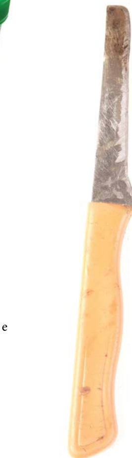
Fig. 1.11.15: faca para desbastar as sobras das soldas
