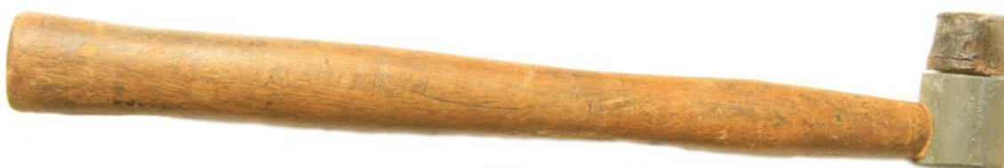
Figs 1.2.20: martelo especial, com cabo de madeira, com encaixe de metal e parafuso na ponta, para adaptar e enroscar a cabeça de acrílico ou alumínio.
