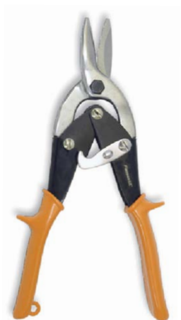
Fig. 1.5.6: Tesoura de aviação (corta-chapa) Usada no corte de chapa fina de metal (latão) para os remendos nos instrumentos danificados com vazamentos.
