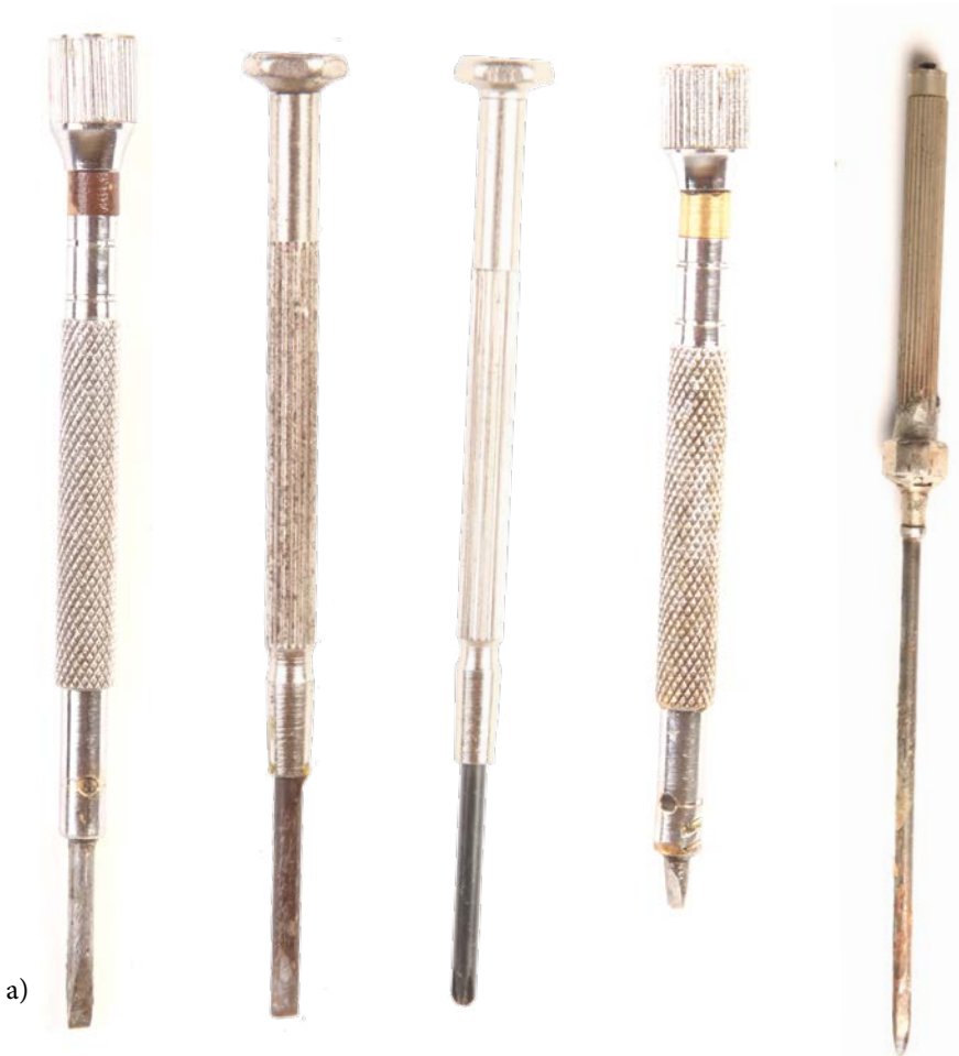
Fig. 1.4.12: Jogos de chaves de fenda especiais, com tamanhos e pontas diversas, para trabalhos principalmente nos micro-parafusos dos instrumentos de madeiras.
