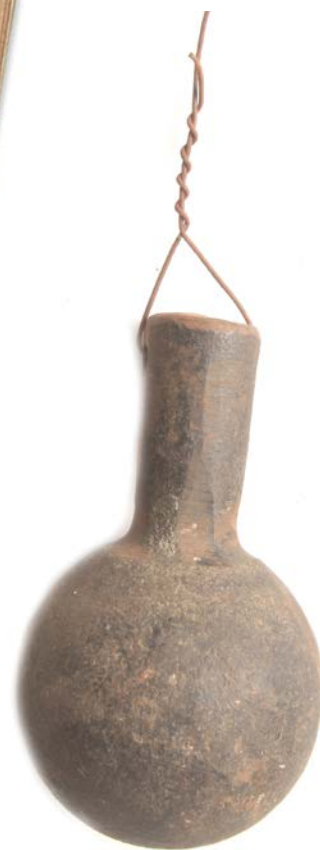
Fig. 1.8.13: Esfera para desamassar tubos grandes de instrumentos como a tuba, o bombardino etc.
