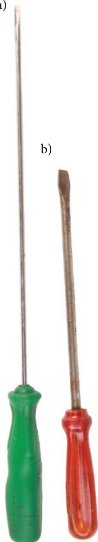
Fig. 1.4.3: Chave de fenda com cabo robusto e cano longo (a), utilizada para os ajustes demonstrados nas fig.s 1.4.1 e 1.4.2, e chave de fenda com cano médio e cabo robusto (b), utilizada no ajuste demonstrado nas fig. 1.4.4 e 1.4.5.
