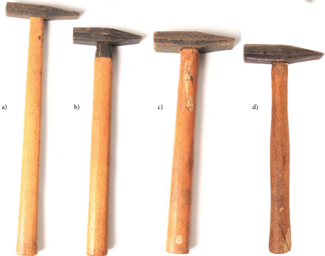
Fig. 1.2.26a, b, c, d: martelos de ferro e cabo de madeira, de uso comum. Não são utilizados diretamente em consertos de instrumentos, mas para preparar molas, cortiças, estojos etc.
