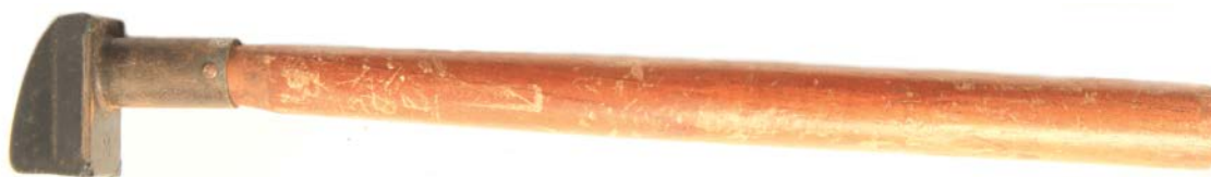
Fig. 1.2.21: martelo especial, com cabo de madeira e ponta fixa de borracha sintética de 150 g.
