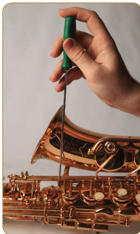
Fig. 1.4.2: Ajuste da articulação da chave de sol sustenido de um saxofone
