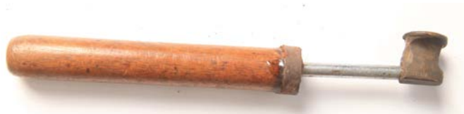
Fig. 1.2.2: martelo de cobre, face plana e redonda, com 1,5 cm, de 100 g e cabo longo de madeira.
