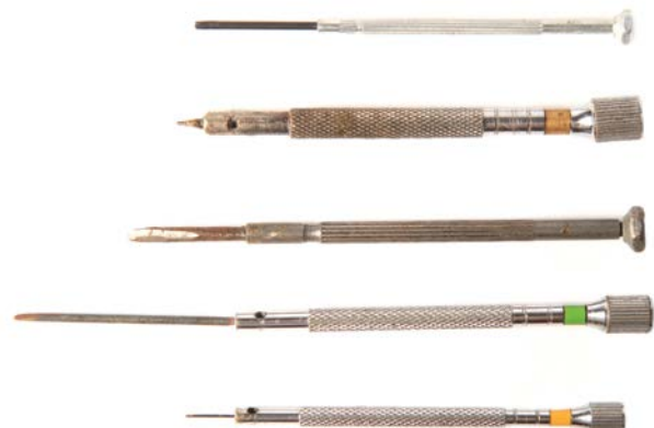
Fig. 1.4.7: Jogo com cabo rotativo. Sua principal atuação dá-se nos instrumentos de madeiras que estão com os parafusos bem lubrificadas, para facilitar a regulagem ou remoção.
