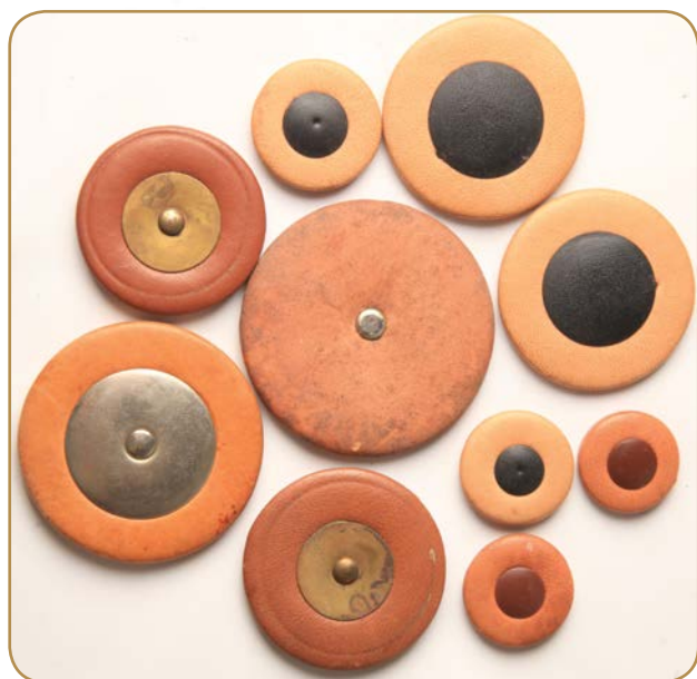
Fig. 2.7.2: Sapatilhas prontas para saxofone, feitas com pêlo de cabrito.
