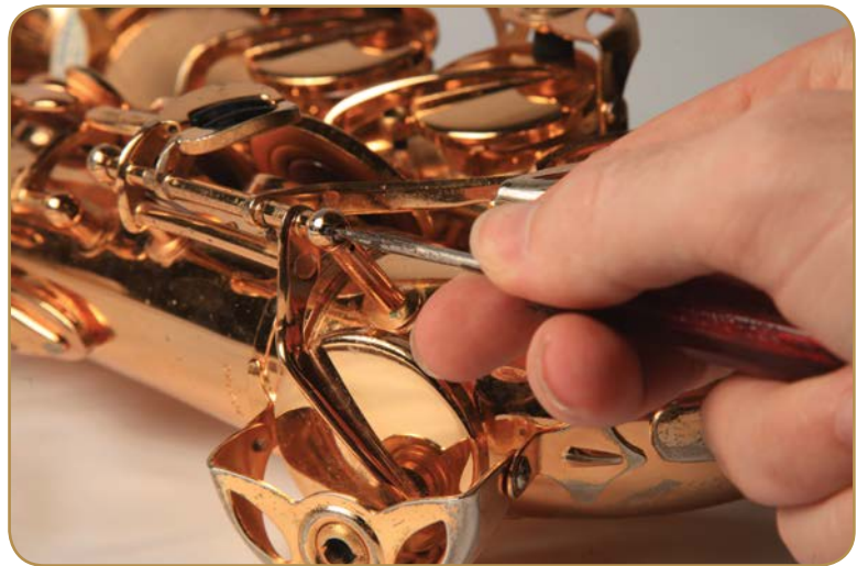
Fig. 1.4.4: aperto do parafuso das chaves de dó e mi bemol grave de um saxofone
