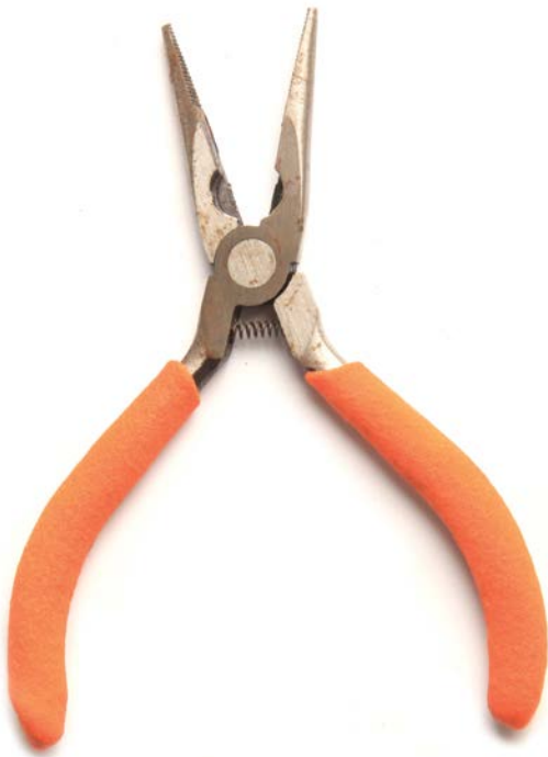
Fig. 1.3.17: alicate de bico fino, com corte e estria – ajuste de mola
