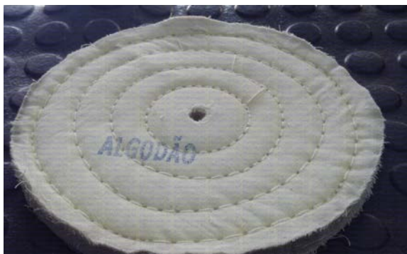
Fig. 1.6.10 a: Disco de polimento de tecido de algodão
