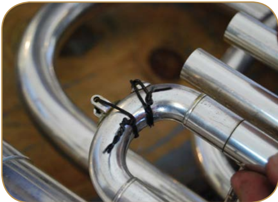
Arame queimado (ou cozido), do tipo usado em obras. Ideal para fixar as peças a serem soldadas;
