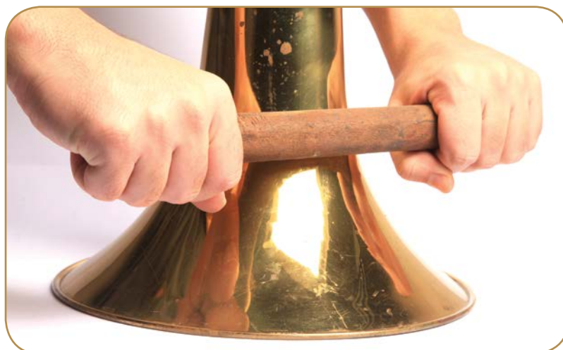
Fig. 1.8.22: pedaço de madeira roliço, utilizado para o desamassamento de campânula. Perceba que o procedimento de desamasso é similar ao feito pelo borneador curvo
