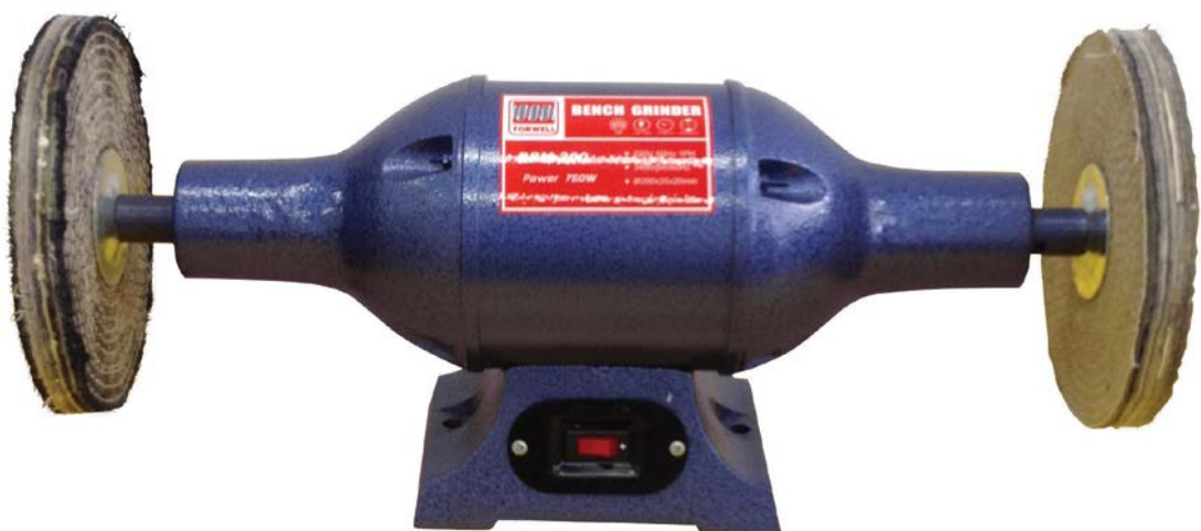
Fig. 1.6.9: Moto-Esmeril com discos de polimento acoplados nas extremidades.
