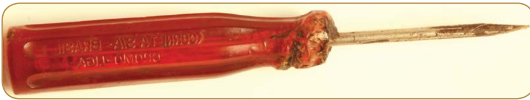
Fig. 1.4.11: Chave de fenda com ponta fina, para inserção de óleo lubrificante nas juntas dos parafusos, e pequenos ajustes de mola.
