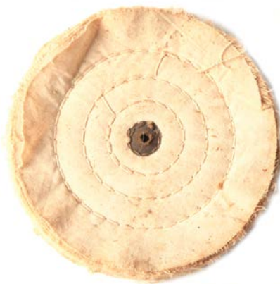
Fig. 1.6.10 b: Disco de polimento de tecido de algodão
