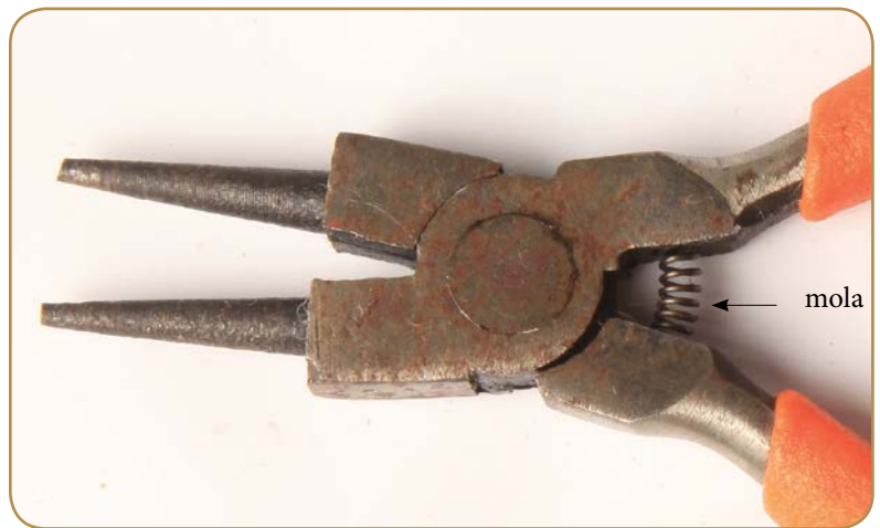
Fig. 1.3.26: Alicate bico arredondado e fino, com parte interna chapada, ideal para ajustes de molas. É dotado de mola para automatizar a ação.
