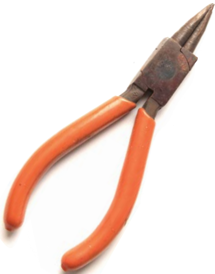
Fig. 1.3.25: alicate bico redondo e fino, para ajustes de mola.
