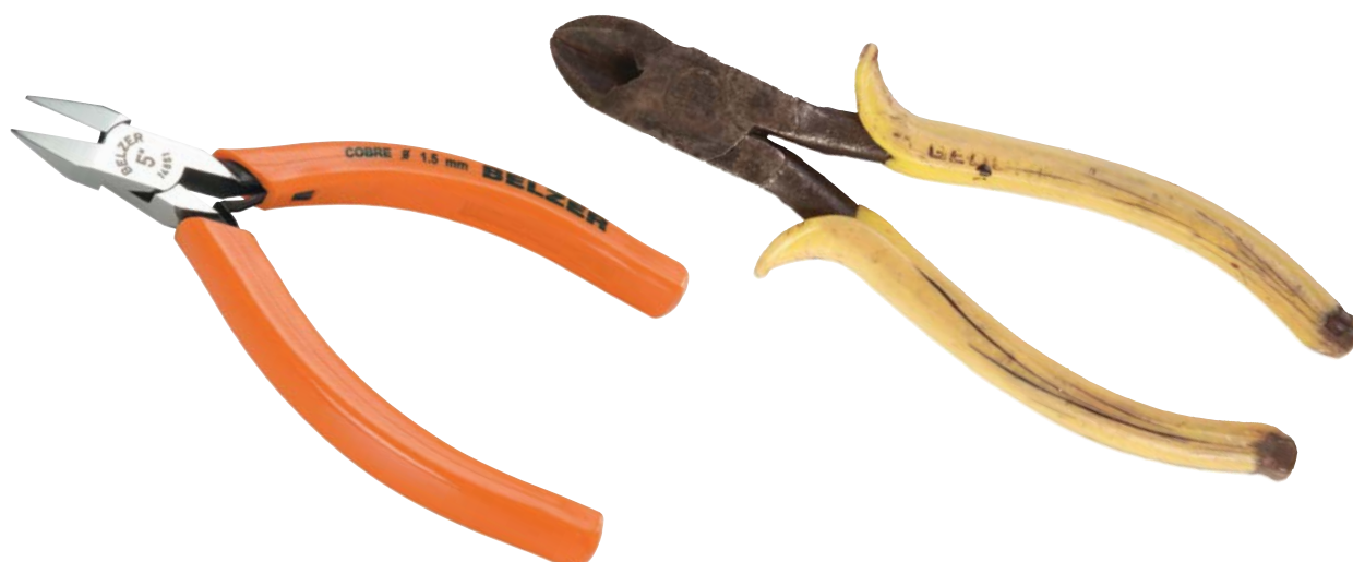
Fig. 1.3.28: Alicates com corte diagonal – utilizados para corte de mola, para o qual se necessita uma medida certa.
