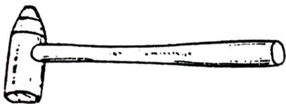
Fig. 1.2.3: Martelo de bronze, duas faces redondas com 1 cm de circunferência, 50 g
